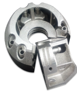
Blasform mit konturnahen Hohlräumen aus LaserForm-Maraging-Stahl (B)
