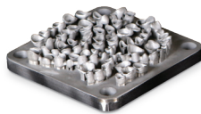
Teilkronen, Kronenkappen und Brücken aus LaserForm CoCr (C)
