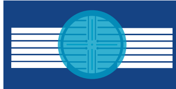
Maschinentisch mit integriertem NC-Rund- / Karusselldrehtisch (in der Mitte des Tisches angeordnet)
